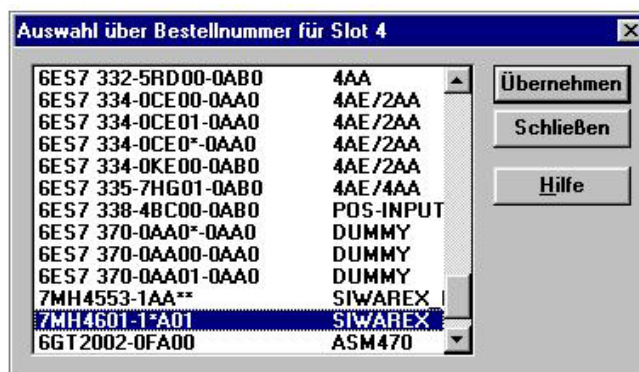
Рис. 7-1 Выбор модуля SIWAREX U при конфигурировании ET 200M
